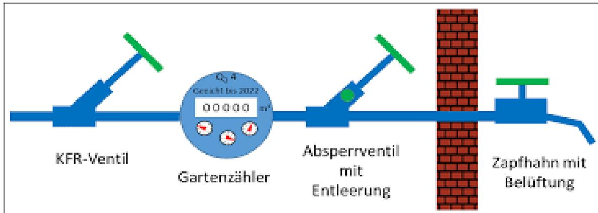
Um den spannungsfreien Einbau des Gartenzählers im Leitungsnetz zu gewährleisten, wird die Verwendung einer Wasserzählergarnitur empfohlen.
